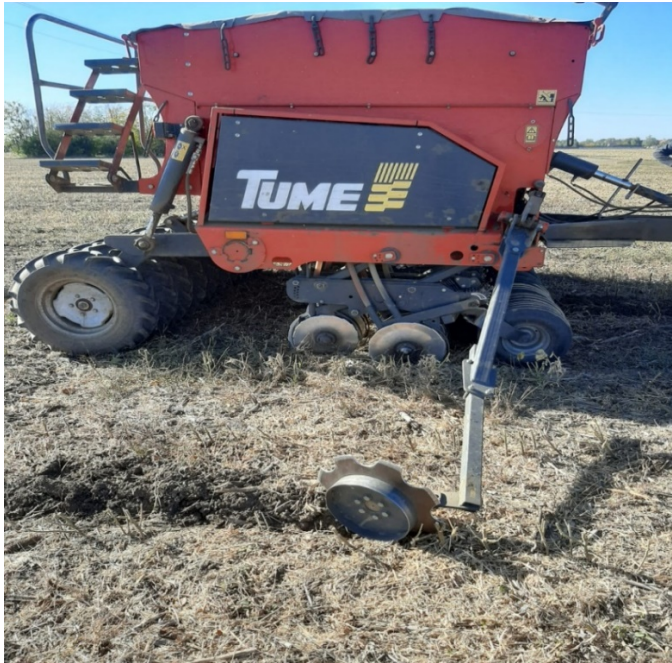
Figura 10. Semănătoare Tume Nova Combi 3000 pentru semănat direct 16
