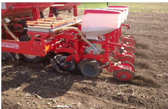
Figura 14. Echipament de semănat direct pe semănătoarea Gaspardo Regina 20
